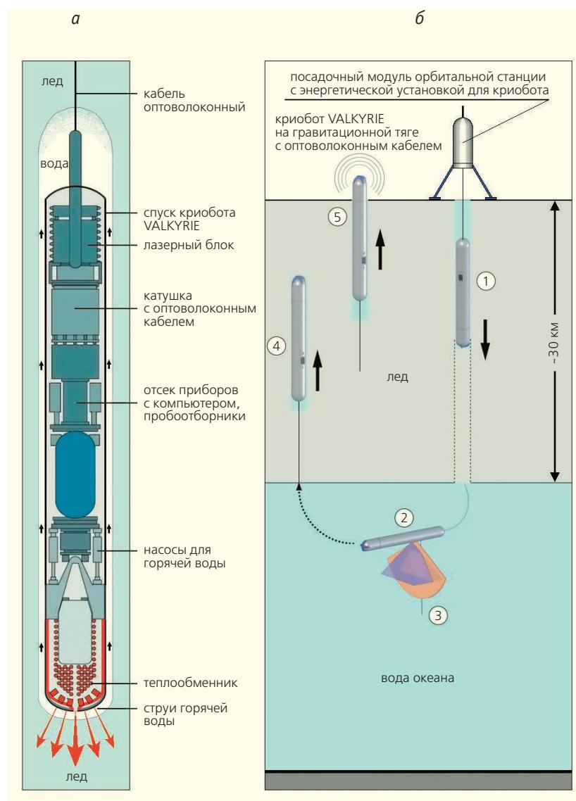
Рис.5. Проект НАСА для исследования льда Европы, спутника Юпитера: проектируемый в НАСА криобот VALKYRIE при бурении льда вниз (а); этапы работ криобота VALKYRIE (б): 1 — спуск через лед; 2 — поворот в воде и проход 1 км подо льдом; 3 — съемки рельефа дна боковым эхолотом; 4 — поворот в воде и подъем сквозь лед; 5 — выход на поверхность льда. Рисунок НАСА.
