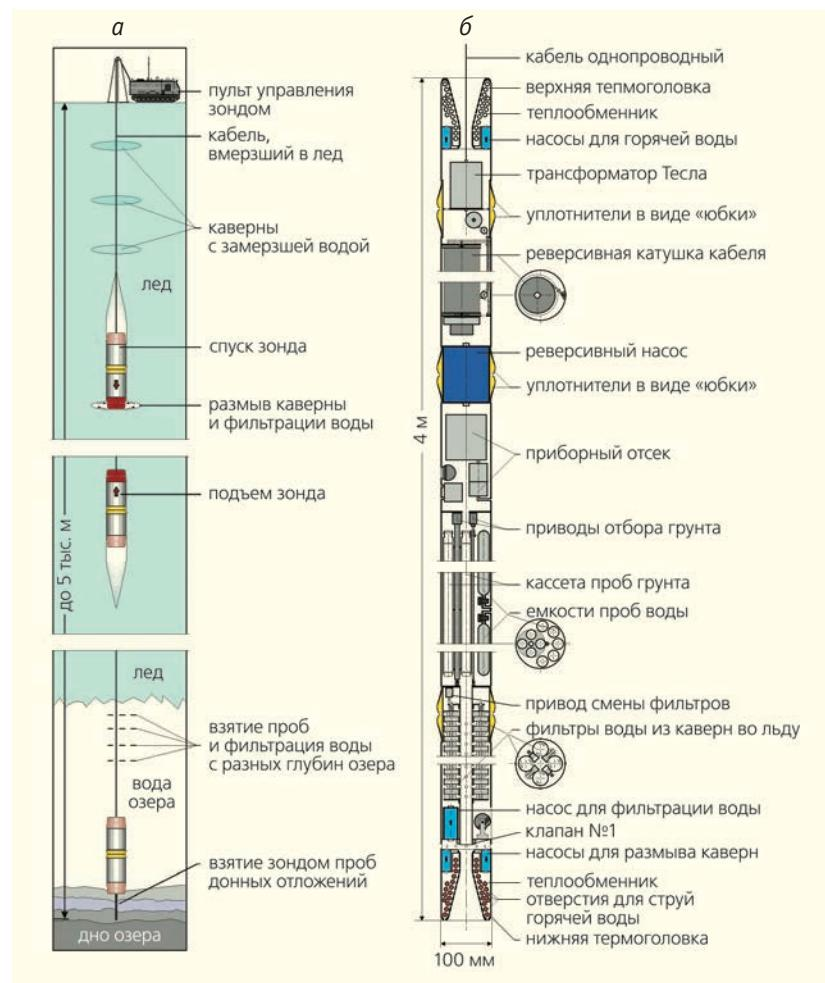
Рис.3. Обшая схема герметичного отбора проб льда и подледниковых сред на Земле (а); принципиальная конструкция ТГБ-зонда для отбора проб талой воды изо льда, воды озера и донных отложений (б).
