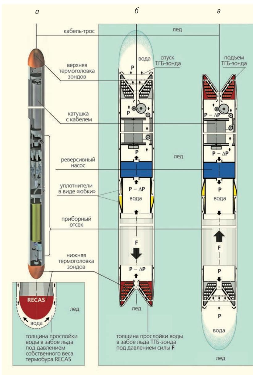
Рис. 2. Эскизные проекты термобуров-зондов для исследования толстых льдов и подледниковых озер без нарушения их ледяной изоляции: термобур RECAS, плавящий лед под давлением собственного веса (показан фрагмент водяной прослойки между льдом и термоголовкой RECAS (а); ТГБ-зонд при спуске в толщу льда под давлением гидравлической силы F (б); бурение ТГБ-зондом льда вверх под воздействием подъемной силы F (в)).
