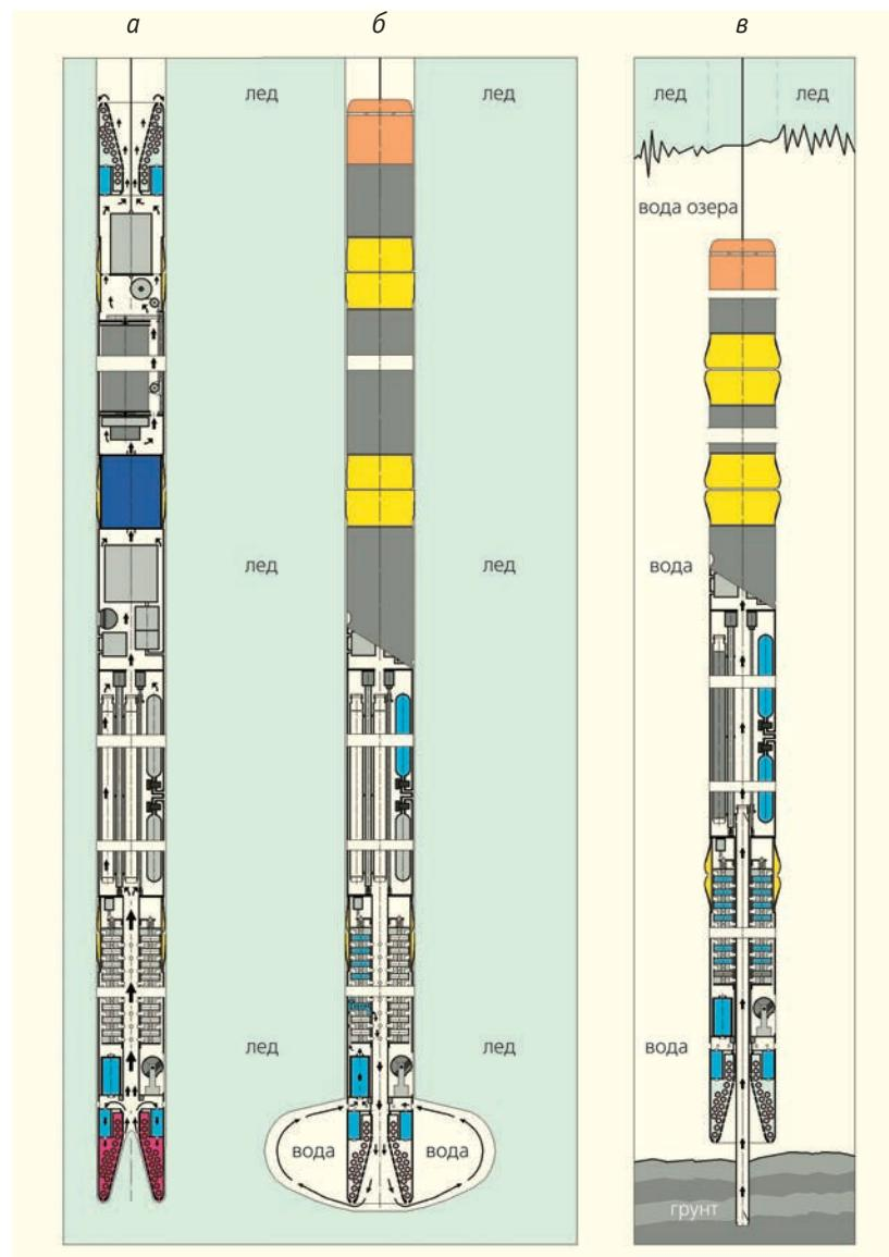
Рис.4. Схемы работы ТГБ-зонда во льду и в подледниковой среде: ТГБ-зонд при движении вниз (а); схема фильтрации талой воды из каверны во льду (б); отбор проб грунта со дна озера (в).
