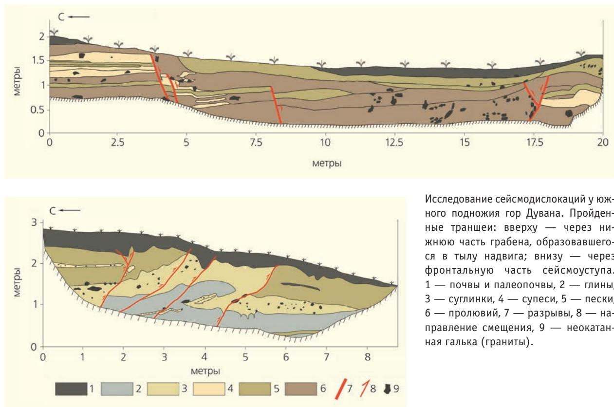
Исследование сейсмодислокаций у южного подножия гор Дувана. Пройденные траншеи: вверху — через нижнюю часть грабена, образовавшегося в тылу надвига; внизу — через фронтальную часть сейсмоуступа. 1 — почвы и палеопочвы, 2 — глины, 3 — суглинки, 4 — супеси, 5 — пески, 6 — пролювий, 7 — разрывы, 8 — направление смещения, 9 — неокатанная галька (граниты).
