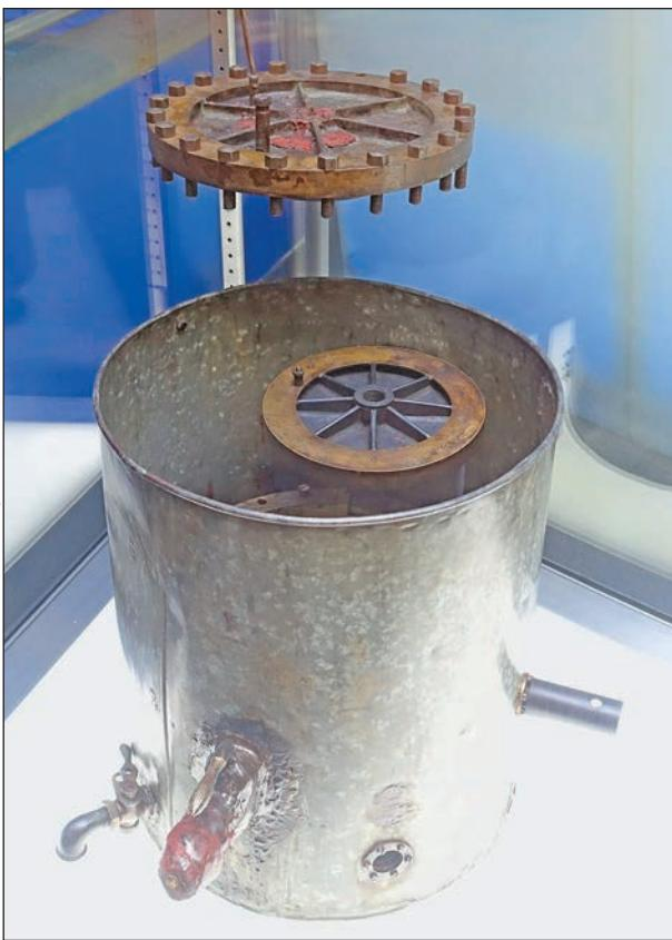
Прибор Милликена для наблюдения за движением капель масла в электрическом поле. Примерно 1916 г. Устройство использовалось Р.Милликеном и Х.Флетчером в нескольких экспериментах по измерению значения заряда электрона. Экспонат Музея науки и промышленности в Чикаго (США).
